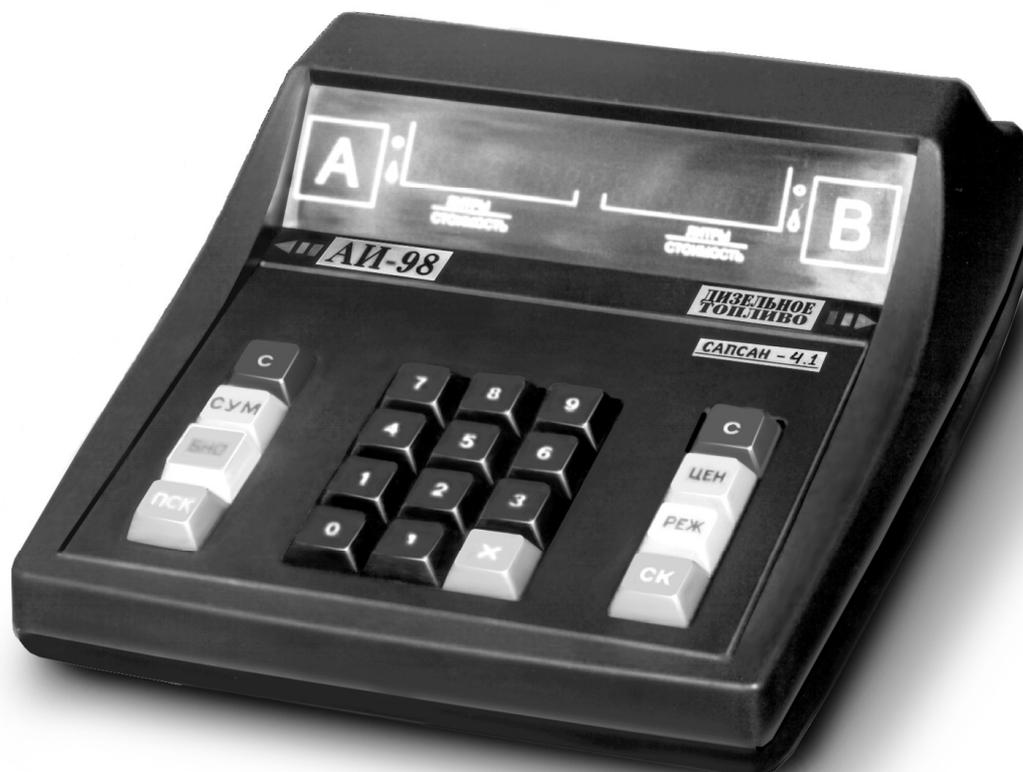
**Рис. 1.** Контроллер управления топливораздаточной колонкой «САПСАН - 4.1».
